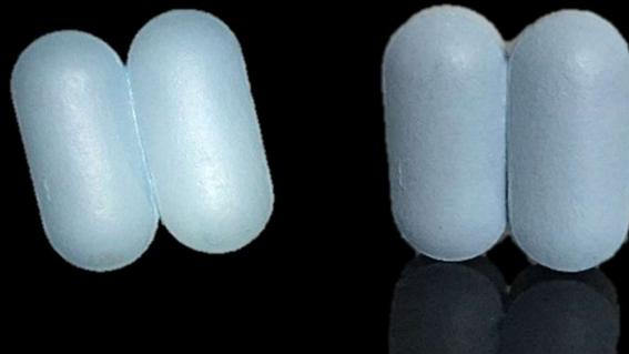
Foto A.03: Formación de gemelos unidos por el área superficial plana más extensa en la tableta. Se muestran dos diferentes tomas del único par de tabletas que tuvo este defecto durante la prueba.
