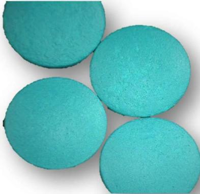
La erosión de la superficie del núcleo puede ser provocada por el exceso de humectación causando que la superficie de la tableta se ablande y, por lo tanto, se vuelva menos resistente a los efectos de desgaste.
