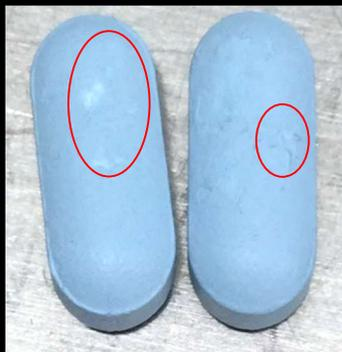
Foto A.02: Las tabletas presentaron problemas de pegado, la zona marcada en la tableta del lado izquierdo muestra el desprendimiento de la película, mientras que en la zona marcada en la tableta de lado derecho se observa una acumulación de película proveniente de otra tableta.
