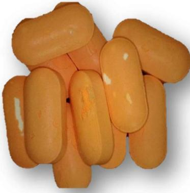
Este defecto se observa cuando áreas aisladas de la tableta se desprenden de la superficie al pegarse los comprimidos unos con otros y posteriormente se separarse dejando zonas en la tableta sin película o algunas otras con la película depositada en la superficie de otro comprimido.
