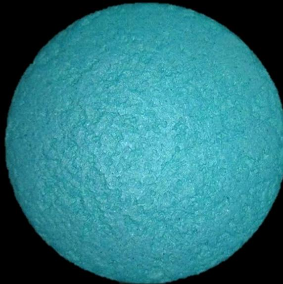
Foto C.02: Esta prueba solo presento un tipo de defecto de recubrimiento, la erosión del núcleo. El núcleo sin recubrimiento es una tableta de superficie lisa e incluso brillante, esta imagen nos muestra la tableta recubierta, por ello sabemos que esa apariencia se debe a un defecto generado durante el proceso de recubrimiento.
