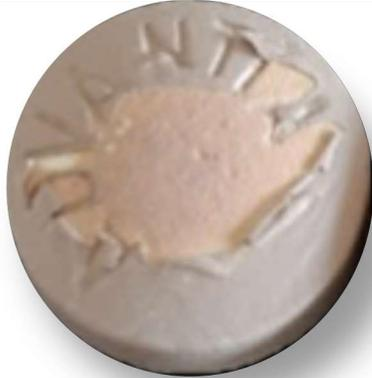
La película de recubrimiento se desprende de la tableta durante o después del proceso de recubrimiento.
