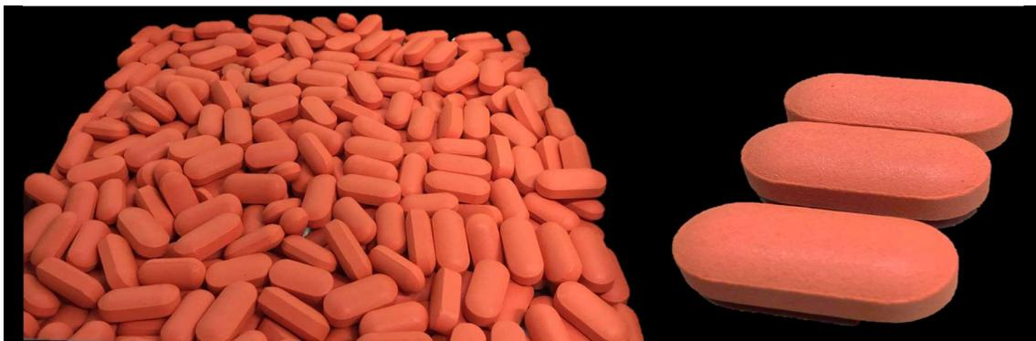
Foto 3. Aspecto general del producto obtenido de la prueba de recubrimiento con AQUARIUS™ Prime PVA. El único defecto detectado en la prueba es la rugosidad.
