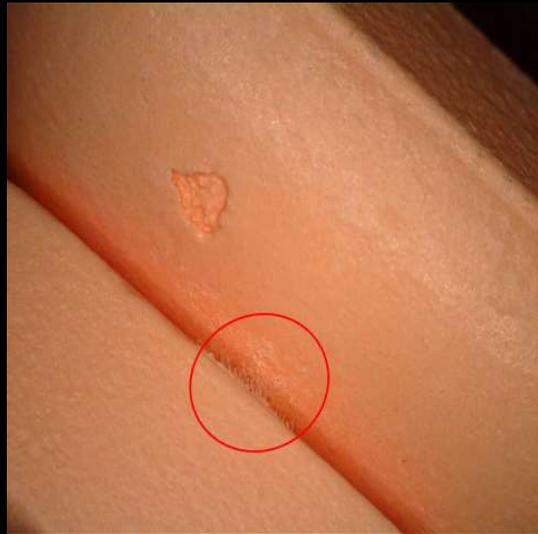
Foto 08: Se puede apreciar más de cerca la unión de la película entre las tabletas que está unida por ciertos puntos de la superficie.
