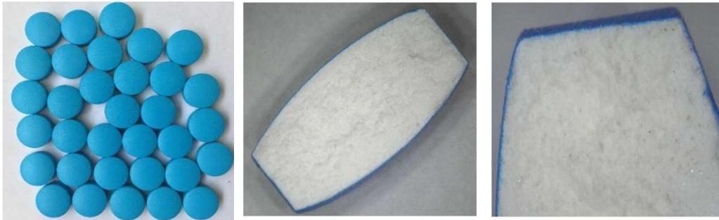
Figura 2: a) Tabletas con recubrimiento estético b) Tableta recubierta cortada de forma transversal, Se puede observar la película de recubrimiento cubriendo el núcleo. c) Acercamiento a la película de recubrimiento estético sobre el sustrato. Imagen del autor
