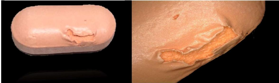
Foto 10: Este defecto se identifica como pelado, la película se desprende del núcleo durante el proceso de recubrimiento ya que se debido a la deficiente adhesividad y puede observar que el núcleo también tiene la cohesión de la película al núcleo.
