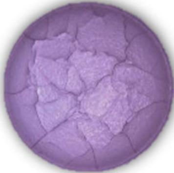
La superficie de la tableta recubierta presenta grietas micro o macroscópicas en su cubierta.
