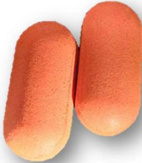
Figura 20: Tabletas recubiertas con rugosidad.
