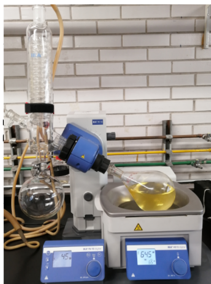
Figura 23. Destilación del extracto metanólico por medio de un rotavapor
