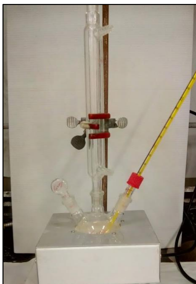
Figura 16. Reacción de transesterificación en medio básico.
