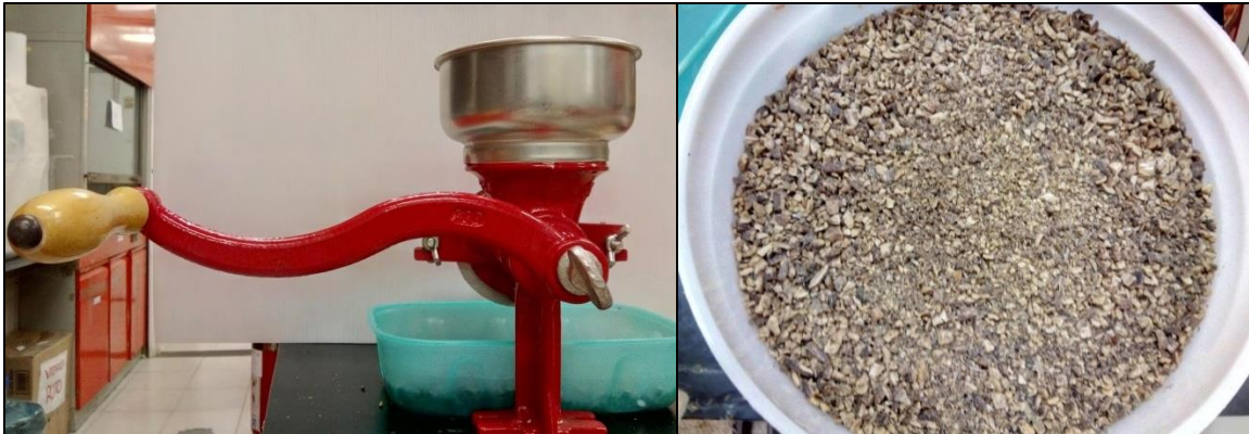
Figura 11. Izquierda: molino manual de granos marca Estrella; derecha: semilla de aceituna molida
