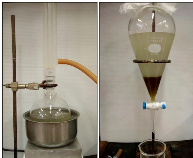
Figura 15. Izquierda: Reacción de esterificación ácida; Derecha: Embudo de separación, fase superior polar (metanol/ \text{H}_2\text{SO}_4 ), fase inferior apolar (aceite y EMAG)
