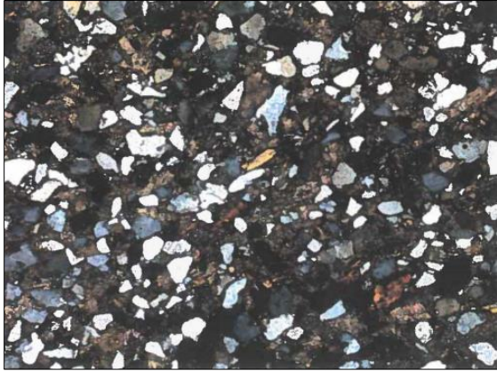
Fig. 6.122. Arenisca del interior de una losa en Baelo Claudia, la cual presenta mayor porcentaje de matriz arcillosa. Vista en luz cruzada. Hoyos et al., 1995: 17.
