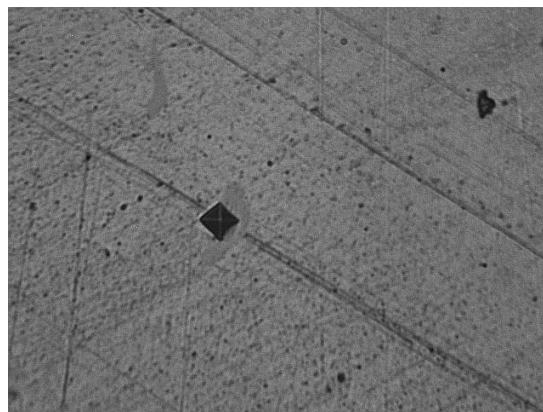
Figura 24 Penetración en intermetálico no homogéneo (40X)
