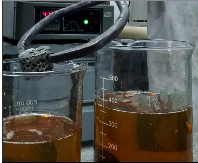
Figura 10 Templado en aceite de motor comercial de espumas metálicas después de solución sólida.
