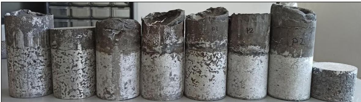
Figura 8 Espumas metálicas después de ser retiradas del sistema, siendo cuatro de cada poro.
