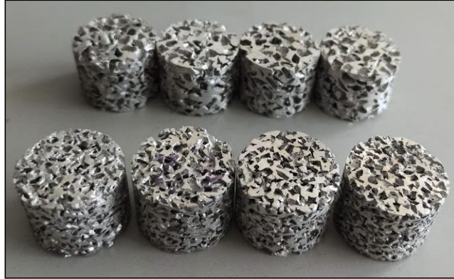
Figura 9 Probetas maquinadas, abajo Poro 1, arriba Poro 2.
