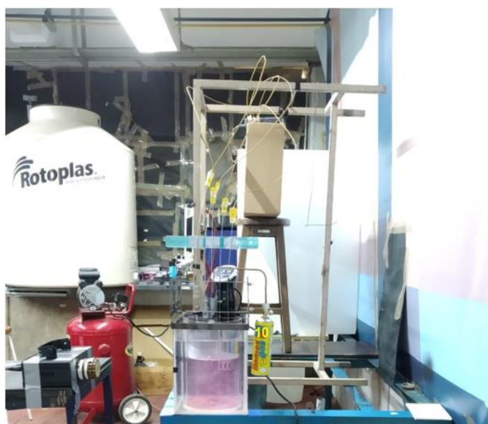
Figura 2.4 Vista lateral del arreglo experimental utilizado en la técnica de PLIF térmico. Descripción de los componentes en Tabla 10.
