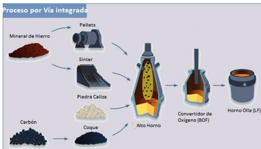
Figura 1.2 Esquema de fabricación de hierro y siderurgia primaria por medio de la vía integrada Alto Horno-BOF. Obtenida de [3].
