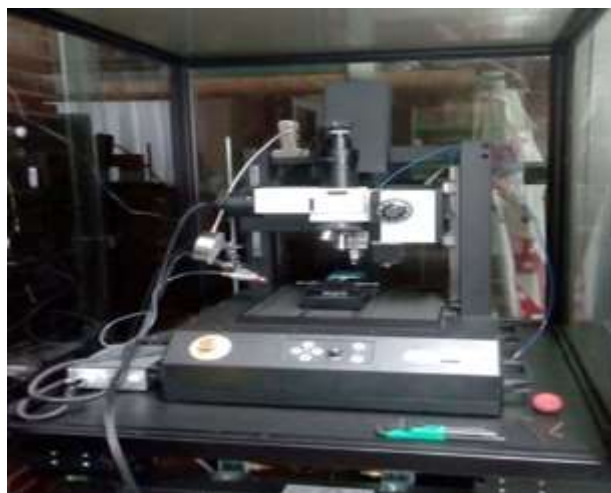
Figura 16.- Nanoindentador Nanovea, MODELO CB500.
