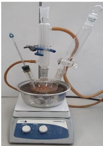
Figura 7. Montaje experimental para la obtención del catalizador de magnetita/nanotubos de haloisita ( \text{Fe}_3\text{O}_4/\text{NTHs} ).
