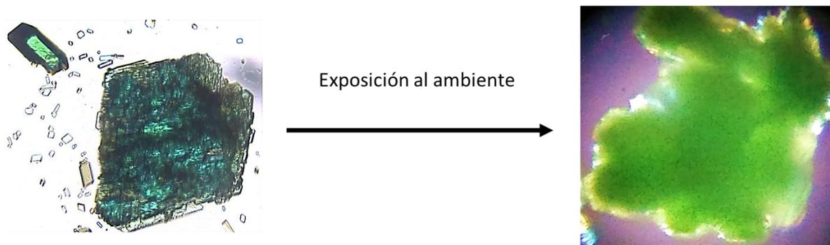
Figura 24. Vista del microscopio antes y después de sacar los cristales del disolvente de la síntesis solvotérmica.
