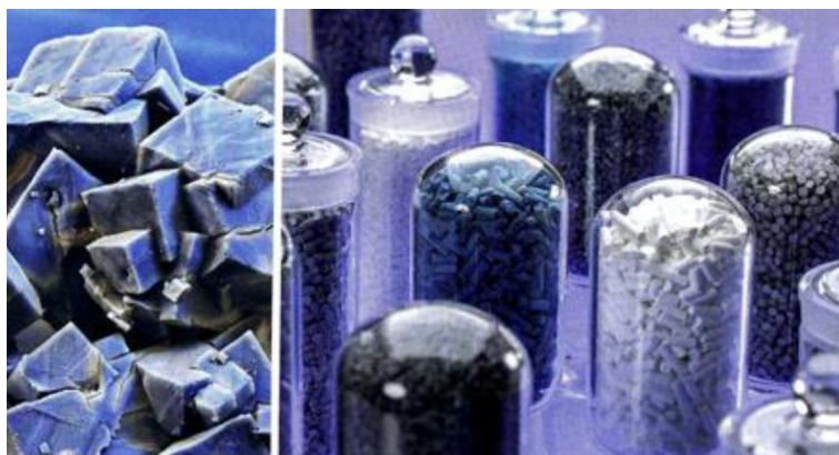
Figura 2.21. MOFs cristalizados de diferentes tamaños para almacenar gas natural (Bolufer, 2014).
