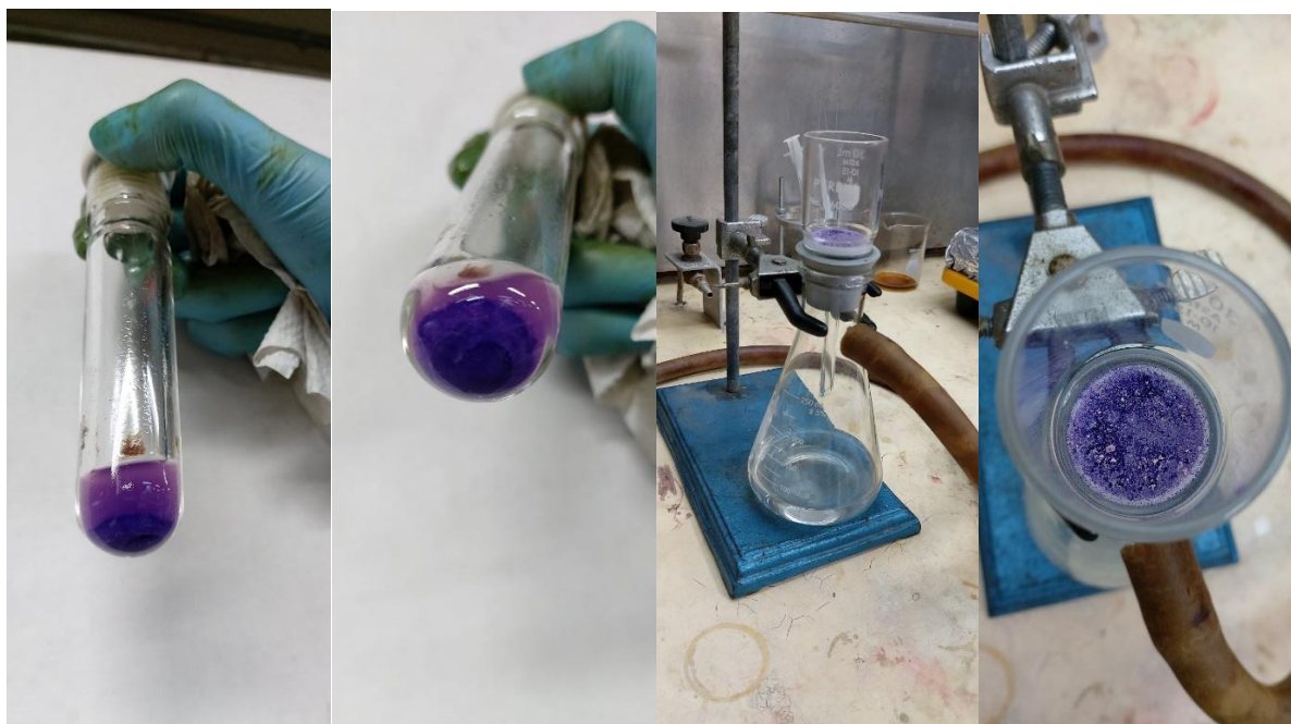
Figura 3.1. Resultado de la reacción solvotermal de la sal metálica y el ligante orgánico.
