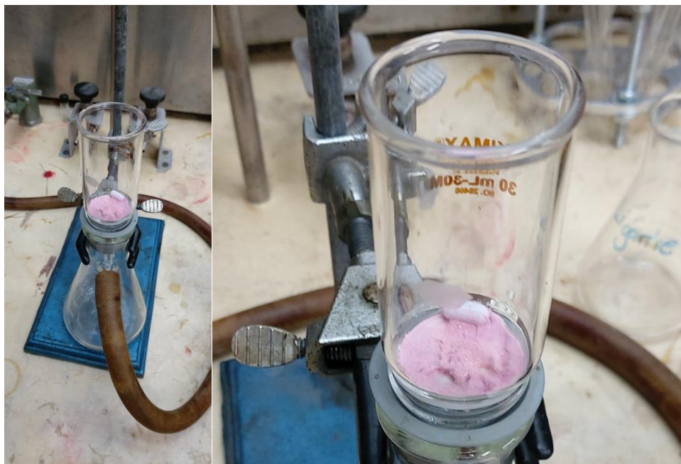
Figura 3.3. Resultado del nuevo método de síntesis. Se observa el color rosado que indica la cristalización de los productos. Este es el proceso de filtrado.
