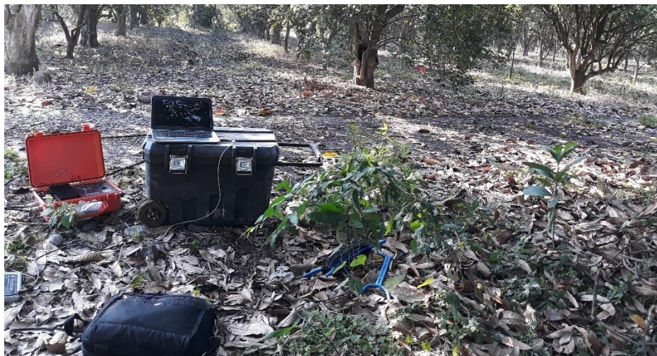
Fig. 13. FastSnap, equipo transitorio electromagnético. a) y b) muestran el equipo transitorio electromagnético FastSnap en campo durante el levantamiento en la cuenca de Chicontepec.
