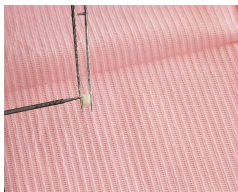
**Imagen 28.** Aplicación del silano sobre la cara de unión del material. (Fuente propia)
