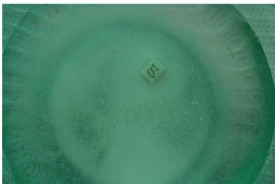
**Imagen 25.** Neutralización del ácido fluorhídrico con bicarbonato de sodio. (Fuente propia)
