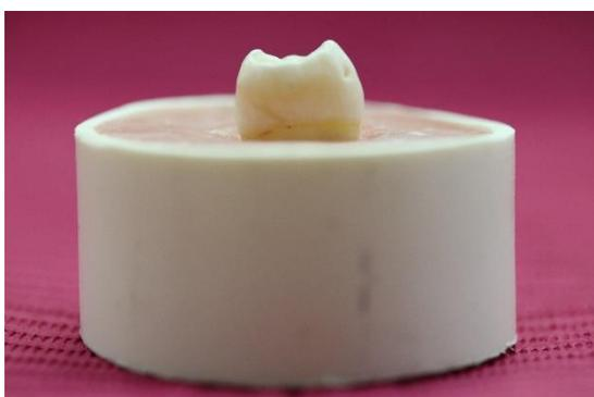
**Imagen 15.** Vista lateral de una muestra sumergida en un anillo de PVC mediante PMMA autopolimerizable. (Fuente propia)
