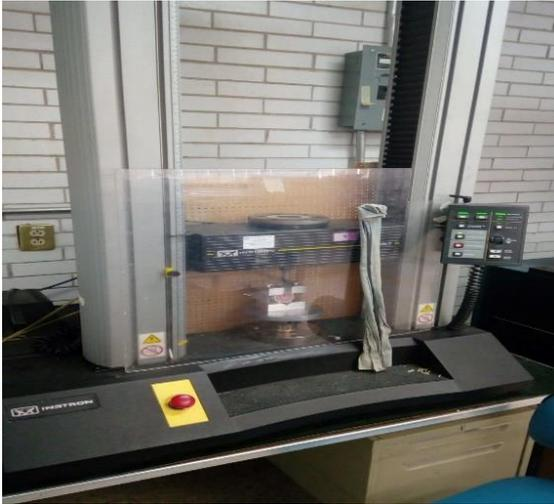
**Image 32.** Máquina universal de pruebas Instron. (Fuente propia)
