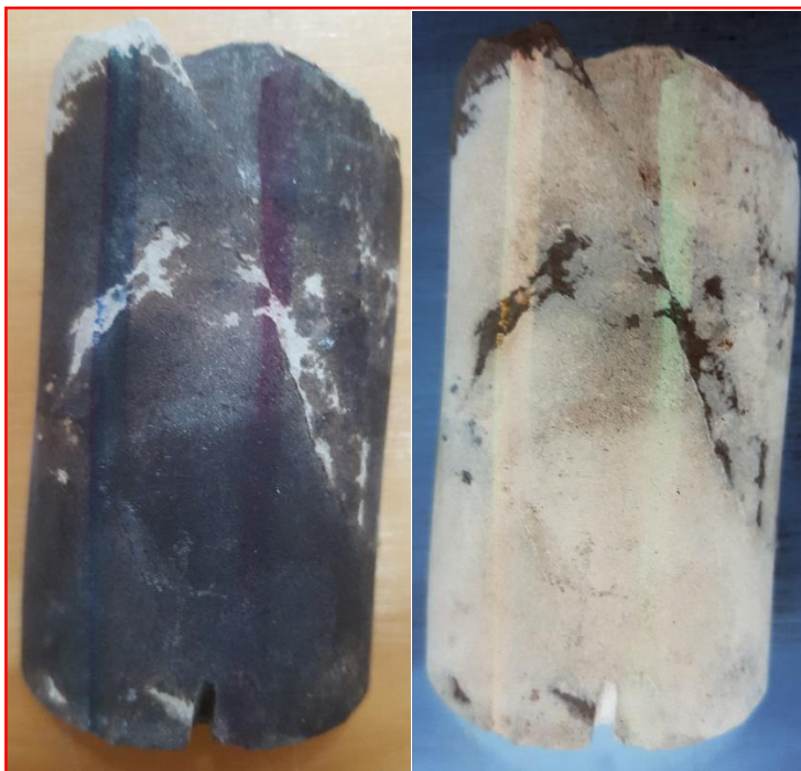
Figura 5.6. Núcleo del Yax-1 con aceite impregnado, en el cual se observan las líneas de referencia vertical del pozo y una fractura de tamaño considerable, la cual podría estar asociada a una falla.
