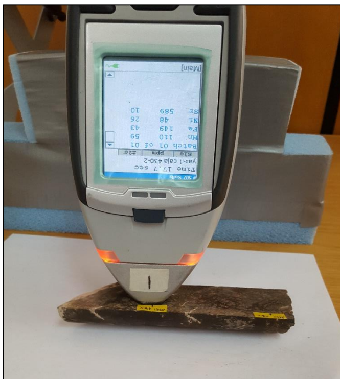
Figura 4.9. Procedimiento de medición de los elementos químicos por Fluorescencia de rayos X de los núcleos del Yax-1, mediante el equipo Niton XL3t.
