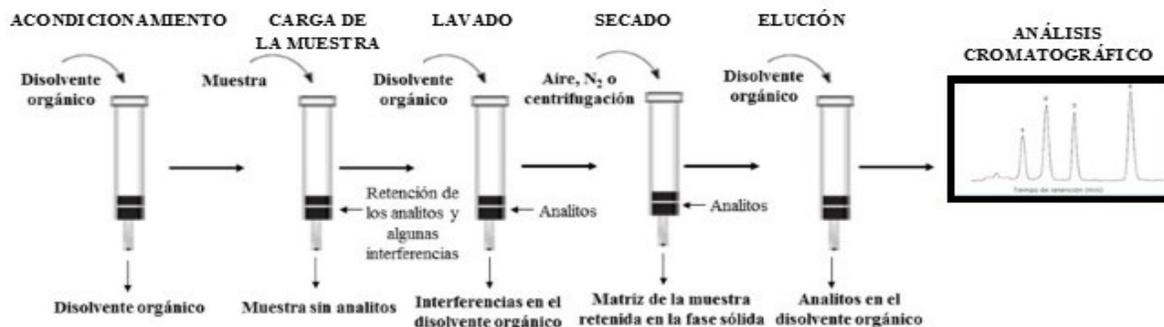
Figura 2.5. Procedimiento típico de la extracción en fase sólida (Andrade *et al.*, 2016)
