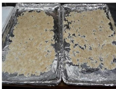
Figura A.4.4. Preparación de los residuos lavados y secados a 110°C durante dos horas
