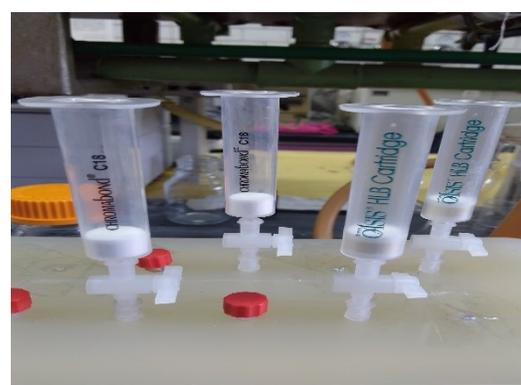
Figura A.4.10. Extracción en fase sólida de plaguicidas triazínicos con cartuchos comerciales HLB y C18
