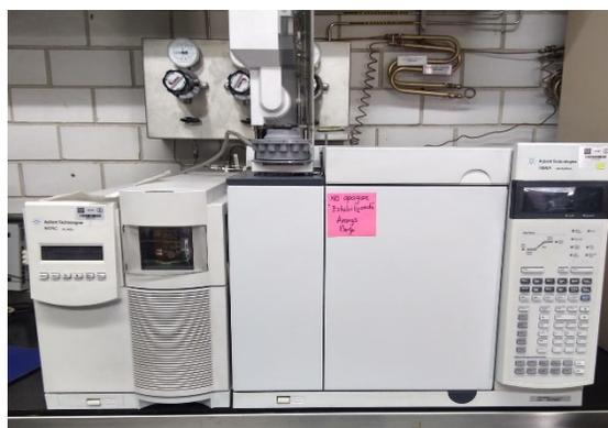
Figura A.4.12. Cromatógrafo de gases Agilent Technologies Series 7890 A con detector de ionización de flama (FID)
