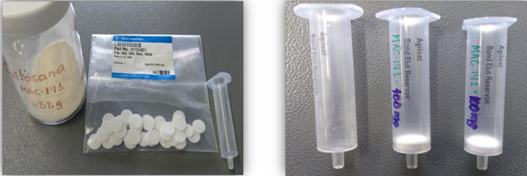
Figura 3.2. Material utilizado en la EFS a) Quitosana obtenida con el sistema  $\text{MeOH-H}_2\text{O-CaCl}_2$ , filtros comerciales y cartuchos de extracción y b) Cartuchos con quitosana obtenida con el sistema  $\text{MeOH-H}_2\text{O-CaCl}_2$  como adsorbente
