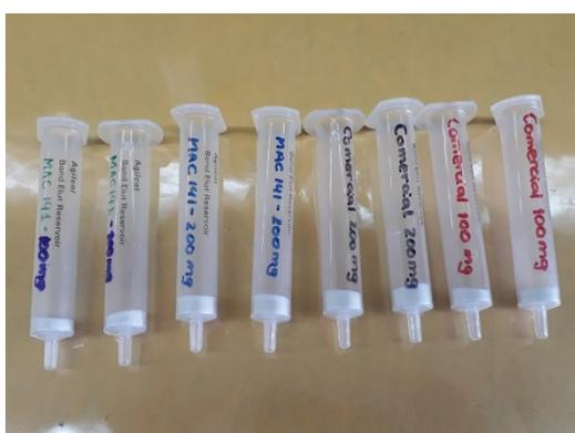
Figura A.4.9. Cartuchos para extracción en fase sólida elaborados con quitosana mineralizada
