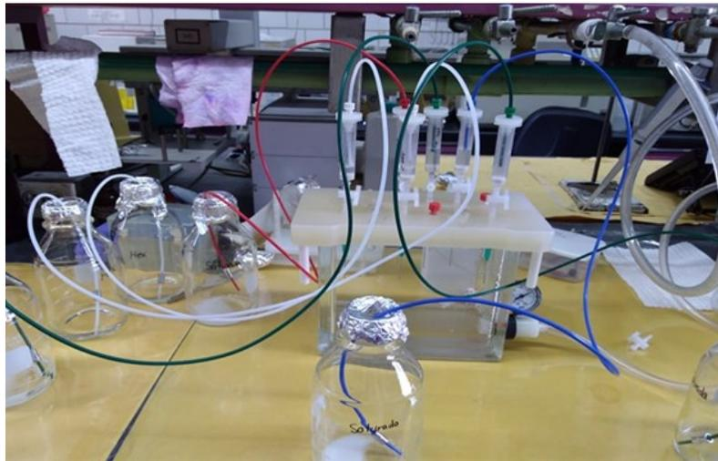
*Figura 3.3. Sistema utilizado para la extracción en fase sólida*
