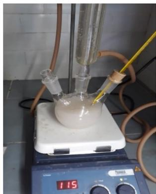
Figura A.4.1. Preparación del sistema MeOH-H<sub>2</sub>O-CaCl<sub>2</sub>
