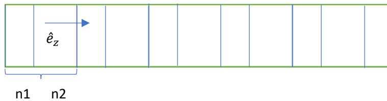
Figura II-1 Arreglo periódico de dos materiales dieléctricos con distinto índice de refracción n_i ( i=1, \dots, \infty )
