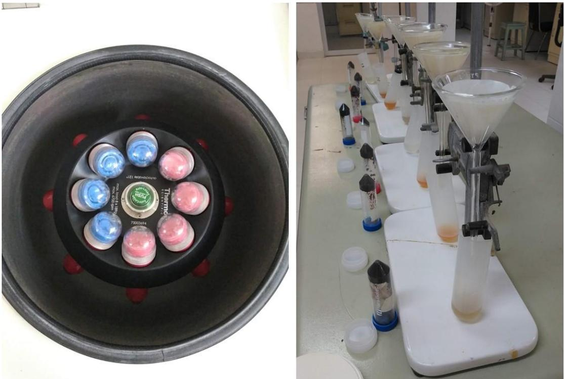
**Figura 13.** Centrifugación (izquierda) y filtración de sobrenadantes (derecha) de los tubos.
