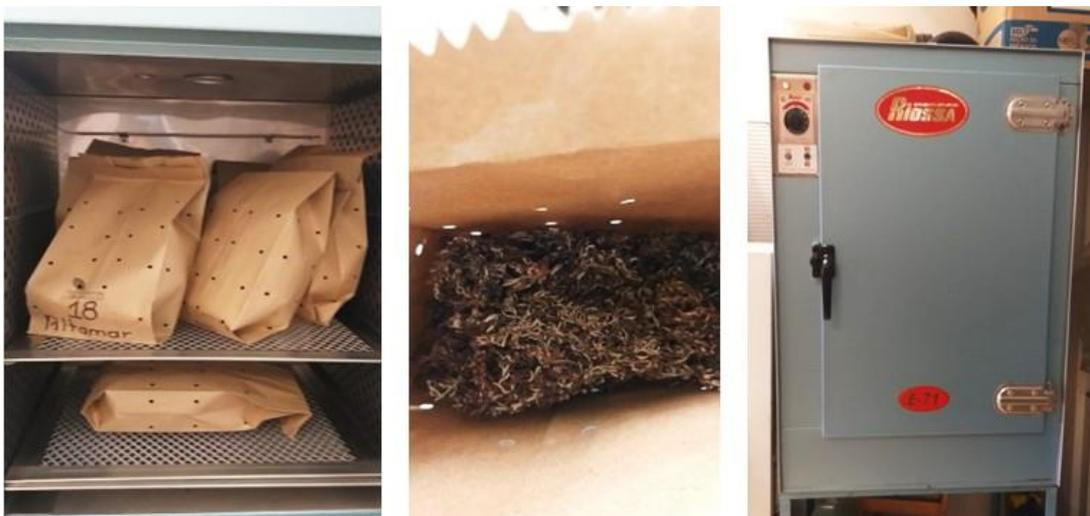
**Figura 9.** Muestras en bolsas de papel perforadas y colocadas en el horno de secado.
