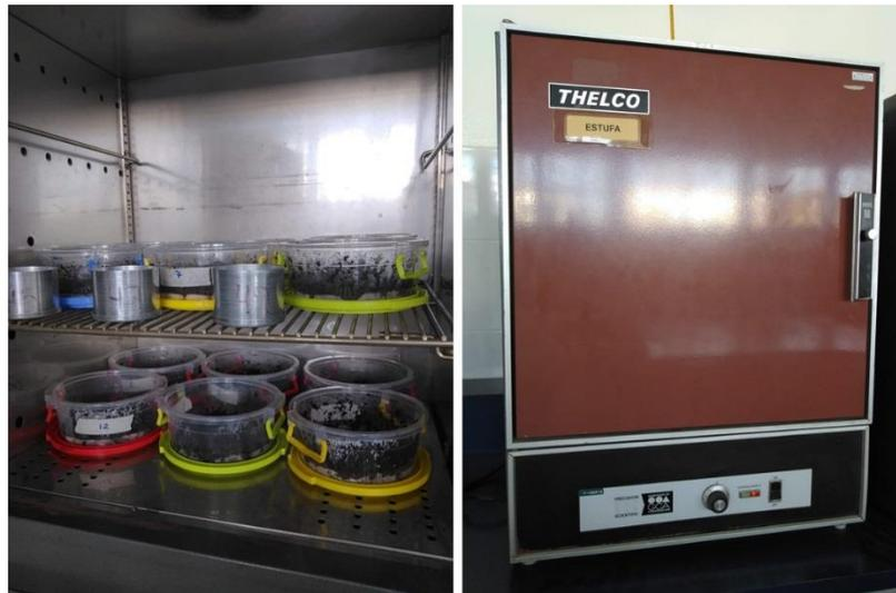
**Figura 11.** Secado final de los tratamientos de compost *in vitro* en estufa con condiciones controladas.
