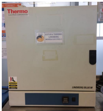
Figura 6.2. Estufa para secado de muestras a 70° C.
