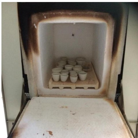
Figura 6.4. Incineración de muestras en mufla a 500°C por 14 h.
