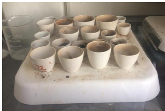
Figura 6.3. Calcinación de las muestras en parrilla de calentamiento.
