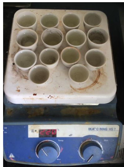
Figura 6.5. Resuspensión de cenizas en parrilla de calentamiento (150°C- 220°C) con HCl al 25%.
