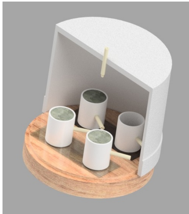
Figura 2.2: Sistema aislado diseñado para el fraguado de las pastas de cemento.
