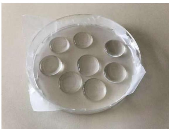
Figura 3.2 | Cubreobjetos de 20 mm de diámetro en una caja de Petri cubierta con parafilm y sobre ellos una solución de 0.1 M de NaOH.
