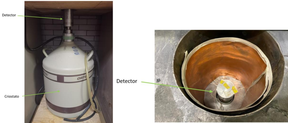
Figura 24. Criostato y detector del equipo de espectrometría (PAD-IFUNAM).
