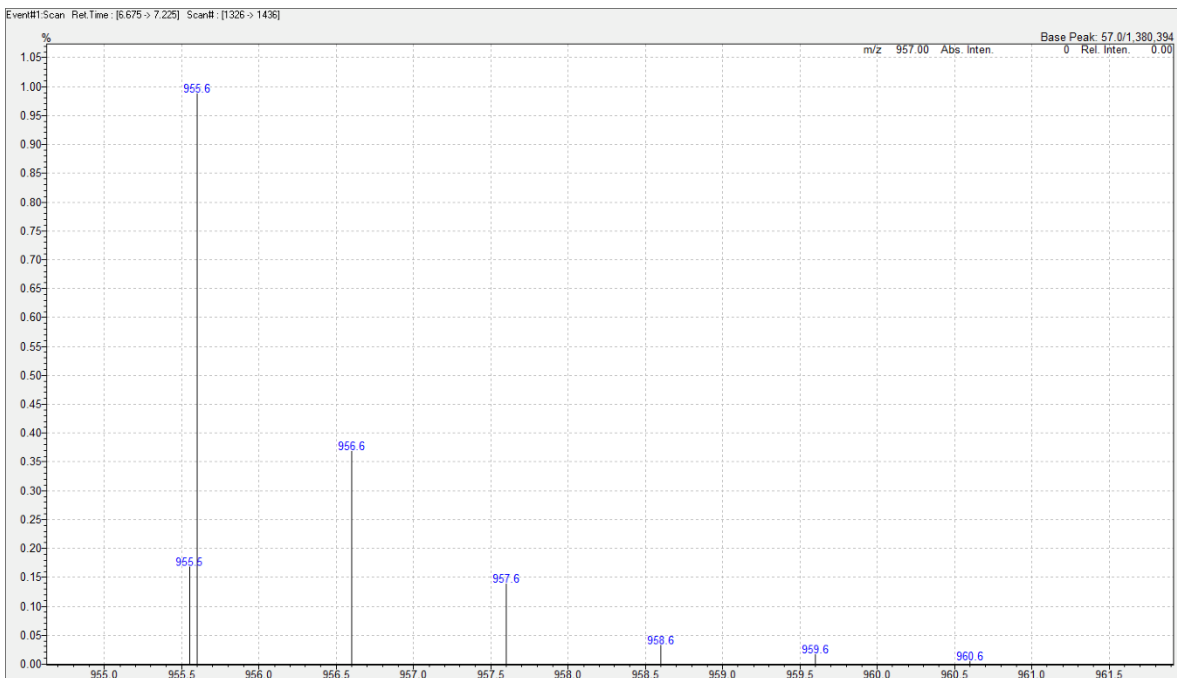
Figura A.37 Espectro de masas de [*L^2]Al_2Me_2
