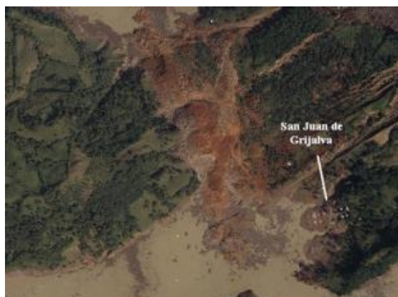
Fig. 2.14. Tapón en el río Grijalva provocado por el deslizamiento de tierra por las intensas lluvias en días anteriores, en 2007 (Fuente: Diversas fuentes de internet).
