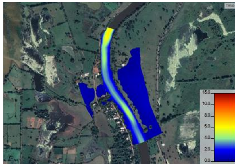
Fig.5.19. Mapa con valores de velocidades para un periodo de retorno 100 años en Hec-GeoRas
