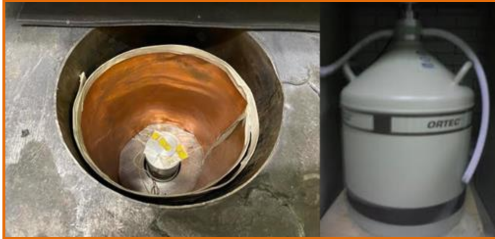
Figura 4.4. Detector con blindaje de plomo y criostato (PAD-IFUNAM)
