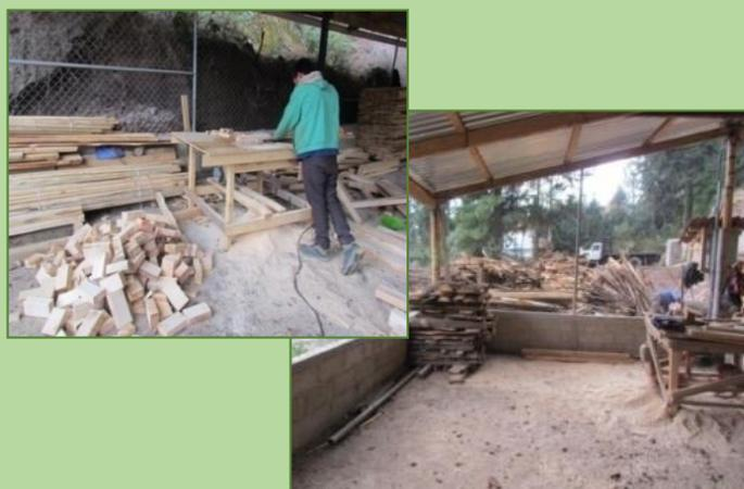
La siguiente etapa consiste en cortar de forma cuadrada la madera ya descortezada. Para este proceso se utiliza el banco circular, el cual corta ancho de la madera, posteriormente se utiliza otro banco circular para dar corte a los largos de la madera. En esta etapa se comienza a separar la madera que va a ser vendida en tabla, tabletas y la que va para madera en tamaños menores, como leña incluyendo aserrín, etc. En este proceso trabajan dos personas.
