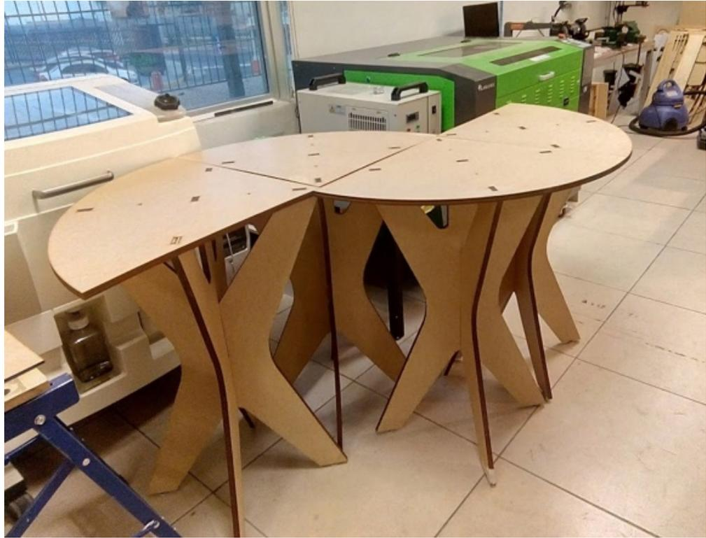
Fig. 8. Laboratorio de tecnología del posgrado en diseño industrial de la UNAM, donde se realizó la producción de las mesas, en corte laser (fotografía realizada por el autor).
