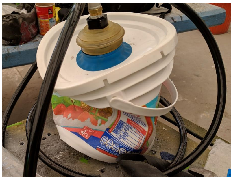
Figura 51 Cámara de vacío comenzando el colapso
