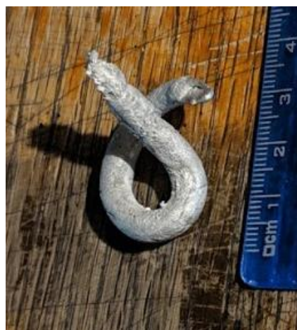
Figura 62 pieza resultado del vaciado del modelo de 6.35 mm
