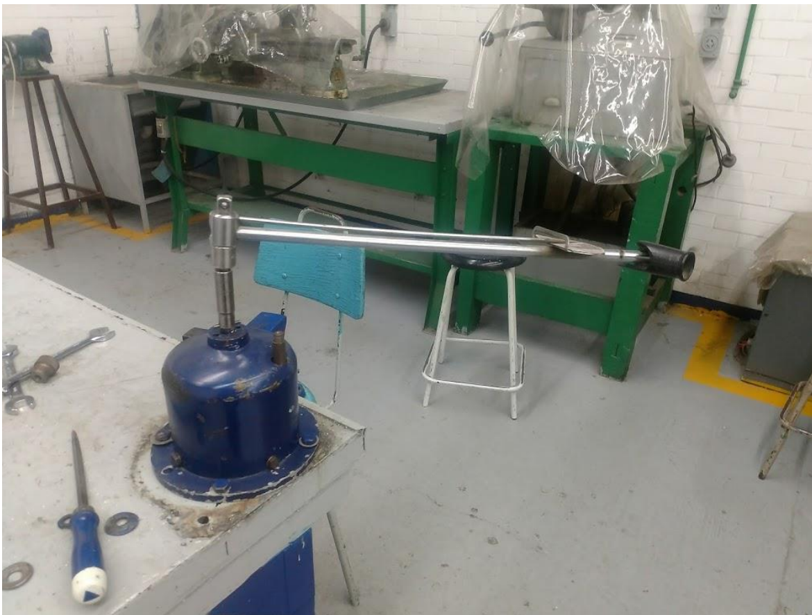
Figura 10 Medición de torque con la máquina dental anclada por medio de tornillos en una mesa de trabajo utilizando los barrenos de un tornillo de banco.
