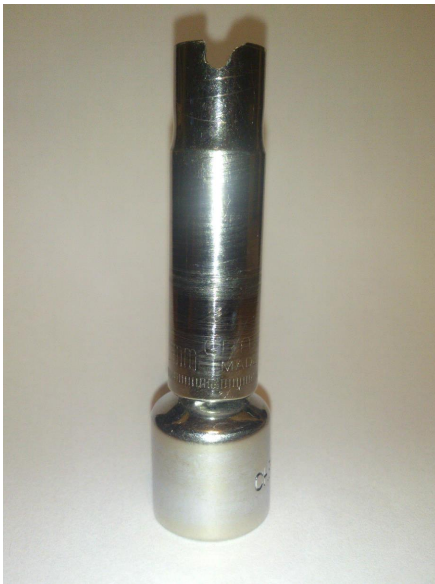
Figura 11 Modificación de dado para poder medir el torque del resorte
