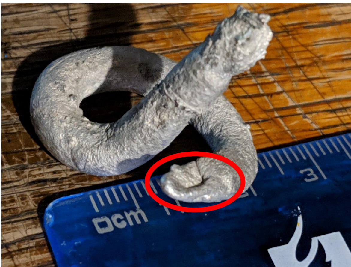
Figura 28 faltante de material en muestra
