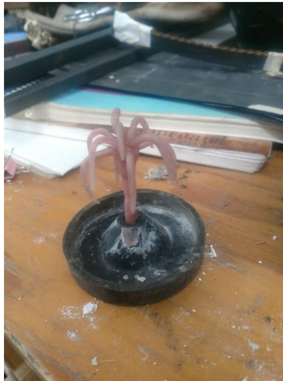
Figura 56 modelo de cera listo para pesar.
