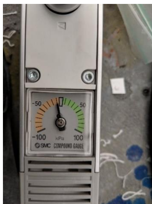
Figura 50 Lectura de manómetro incluido en el módulo SMC
