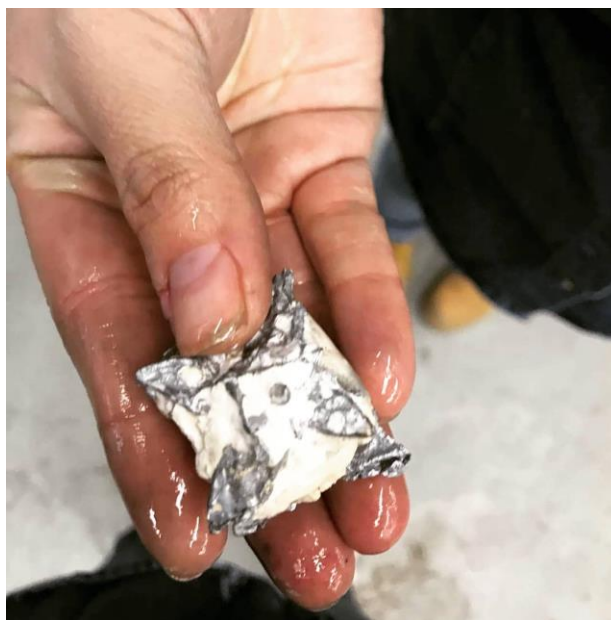
Figura 60 pieza extraída del agua después del rompimiento del molde
