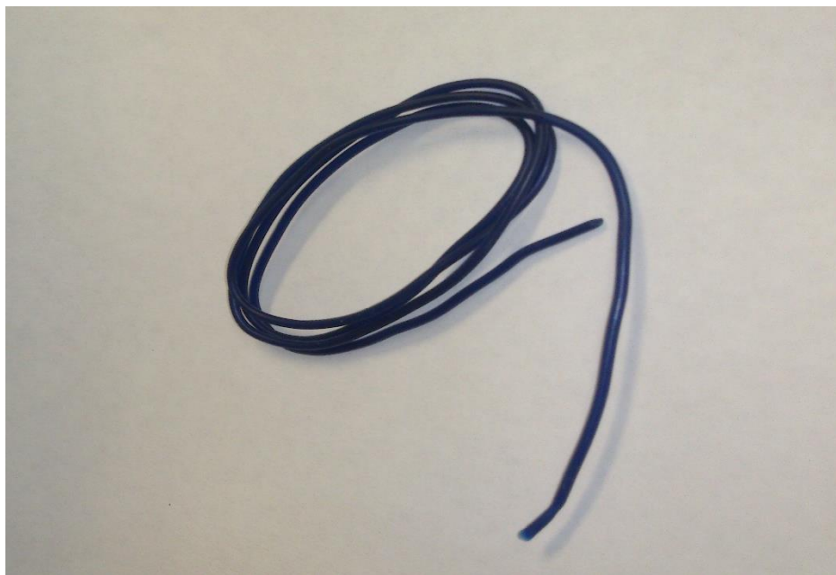
Figura 4 Alambre de cera de 1.5mm de diámetro
