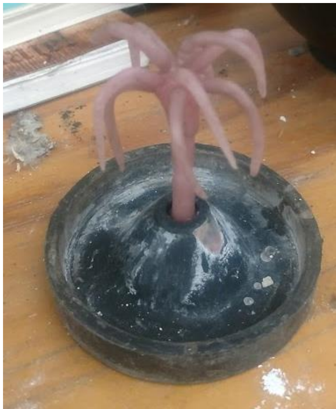
Figura 30 modelo propuesto, ya que este modelo fue utilizado para una prueba de cuál es el diámetro mínimo al cual puede llenar. por lo que el modelo final a utilizar puede tener ligeras variaciones.
