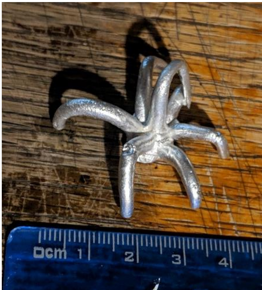
Figura 31 prueba de llenado con modelo en forma de palmera.
