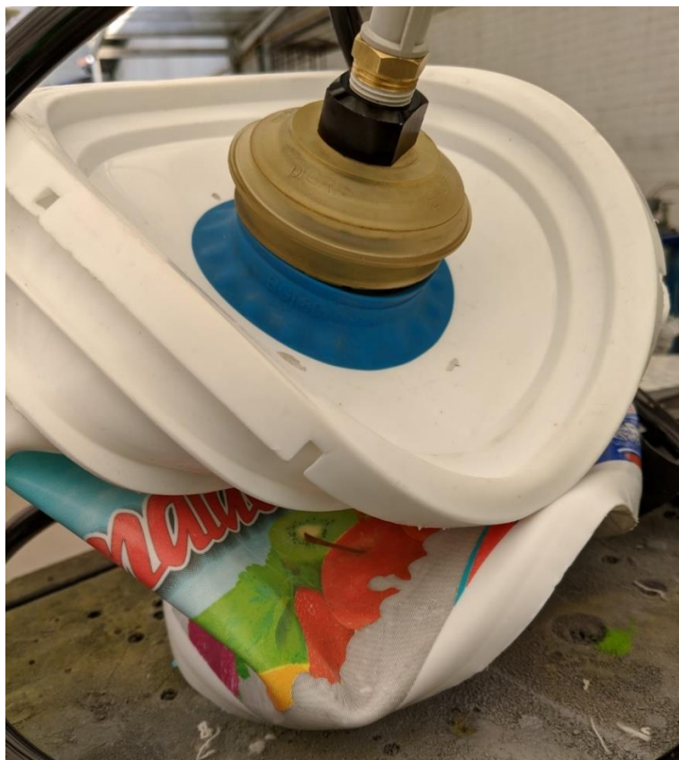
Figura 52 cámara de vacío totalmente colapsada
