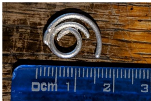
Figura 27 resultado de la espiral para prueba de fluencia en alambre de cera de calibre 1.5 mm
