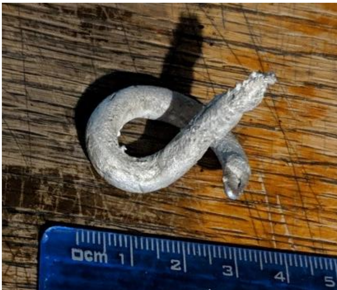
Figura 29 Defectos por molde "húmedo" quedando la superficie opaca y porosa.
