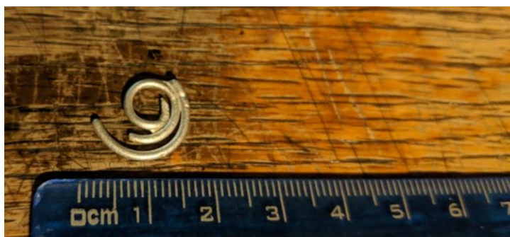
Figura 61 pieza resultado del vaciado del modelo de 1mm.
