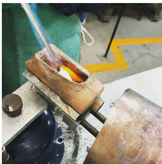
Figura 58 Fusión del aluminio con soplete de oxiacetileno.
