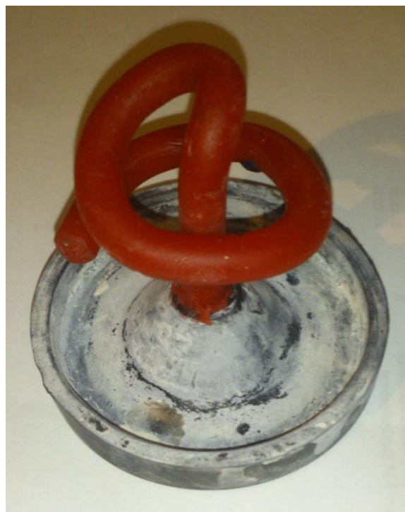
Figura 26 modelo de cera para prueba de fluidez
