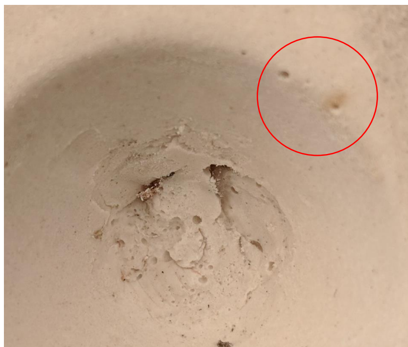
Figura 55 burbuja resultante del uso de cámara de vacío.
