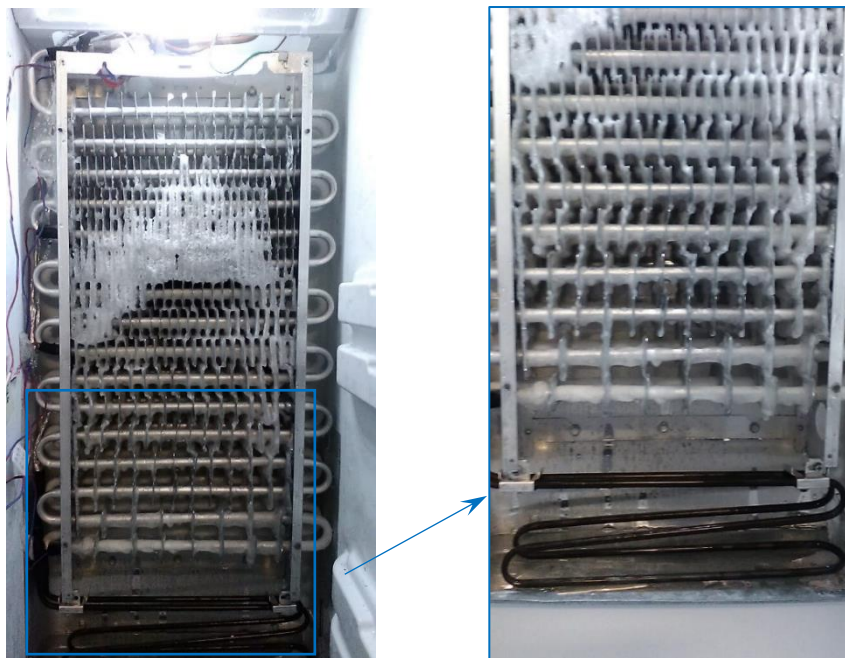
Figura 8. Ejemplo de posicionamiento de una resistencia tubular en un evaporador.
