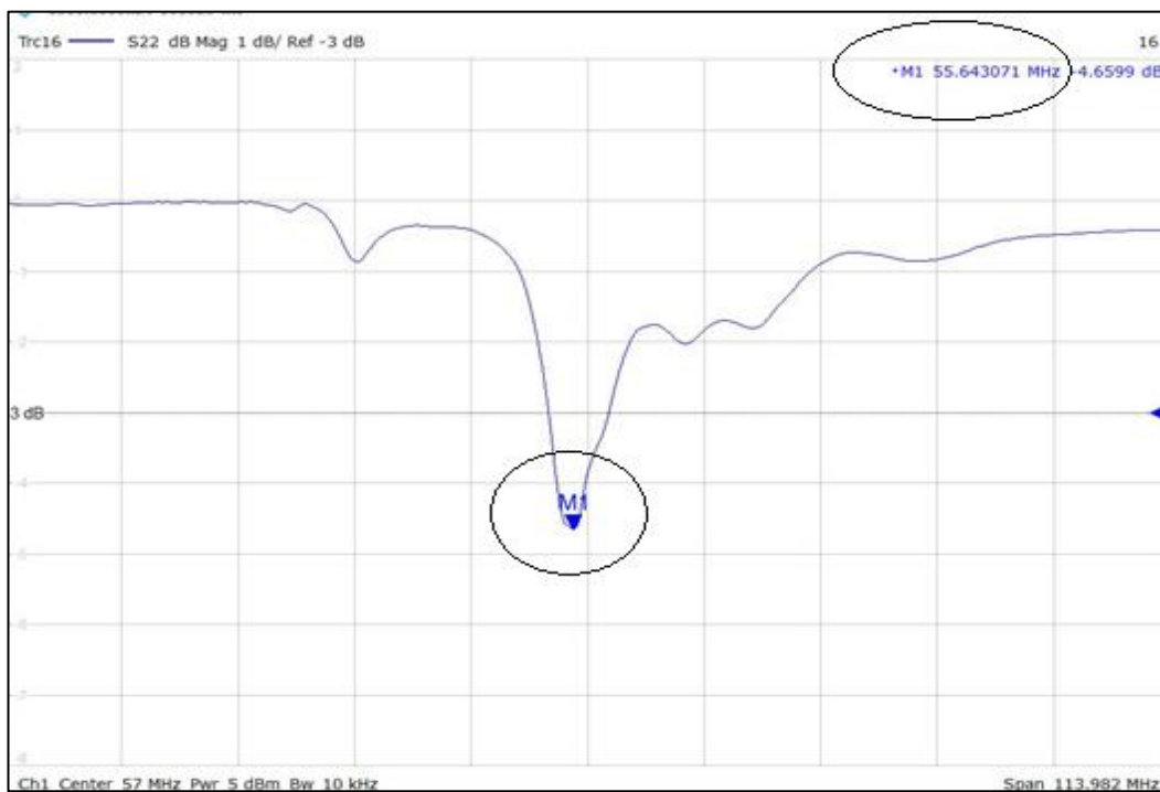
Figura 3.12: Medición de la antena en el Rohde & Schwarz.
