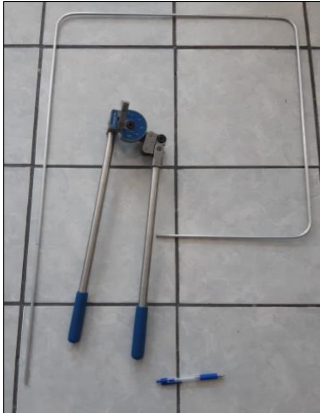
Figura 3.7: Construcción de una antena loop cuadrada de aluminio.
