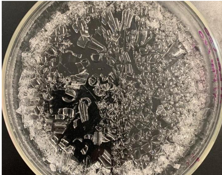
Figura 15 Aspecto de matrices sol-gel sometidas a un secado de 1 día a 65°C.
