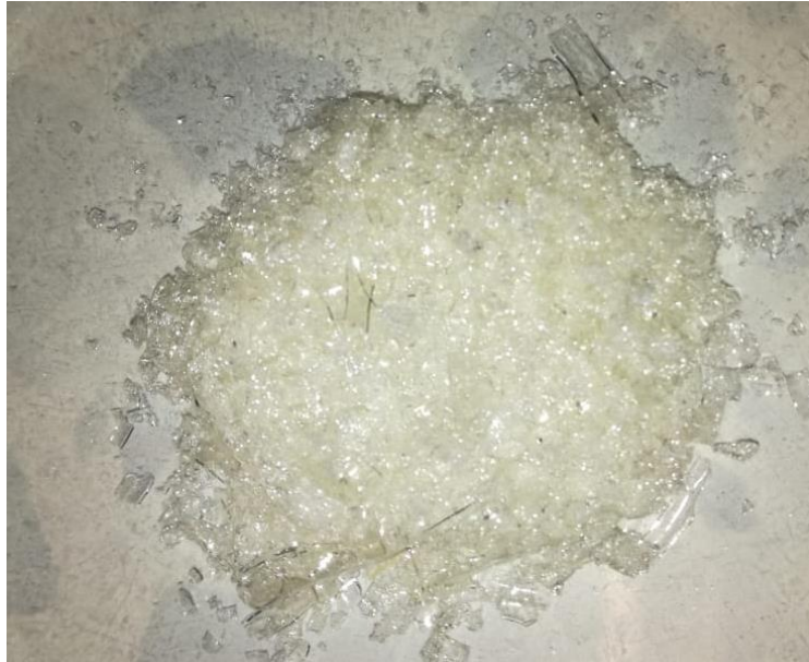
Figura 11 Aspecto de matrices sol-gel cargadas sometidas a un secado a 70°C.
