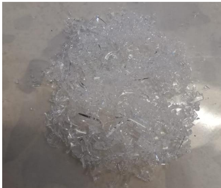
Figura 9 Aspecto de matrices sol-gel cargadas sometidas a un secado a 60°C.
