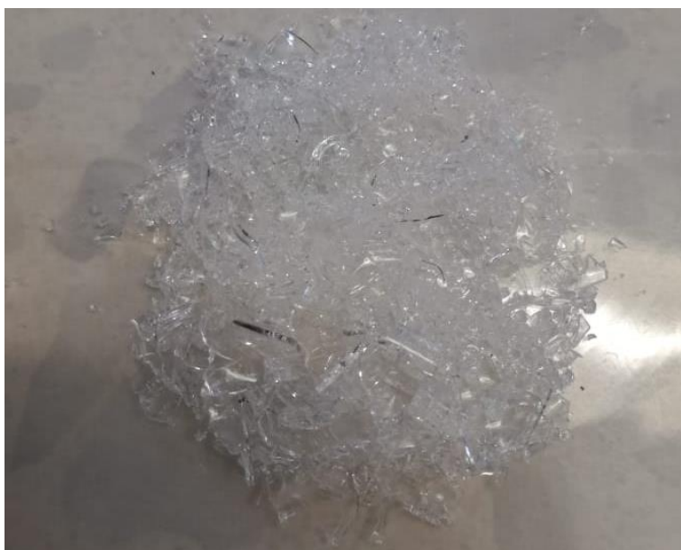
Figura 5 Aspecto de matrices (blanco) fabricadas mediante proceso sol-gel.
