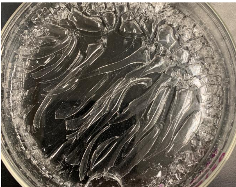
Figura 13 Aspecto de matrices sol-gel sometidas a un secado de 1 día a 60°C.
