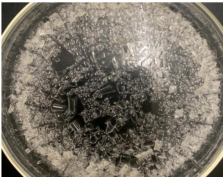
Figura 17 Aspecto de matrices sol-gel sometidas a un secado de 1 día a 70°C.
