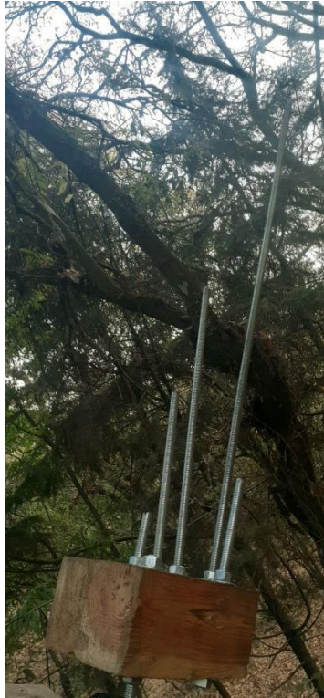
Ilustración 9 Prototipo de pruebas 'Barras encastradas' serie de barras 1, 1/2, 1/4, 1/16, 1/32
