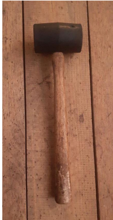
Ilustración 10 Mazo para percutir (parte superior suave, parte inferior dura)
