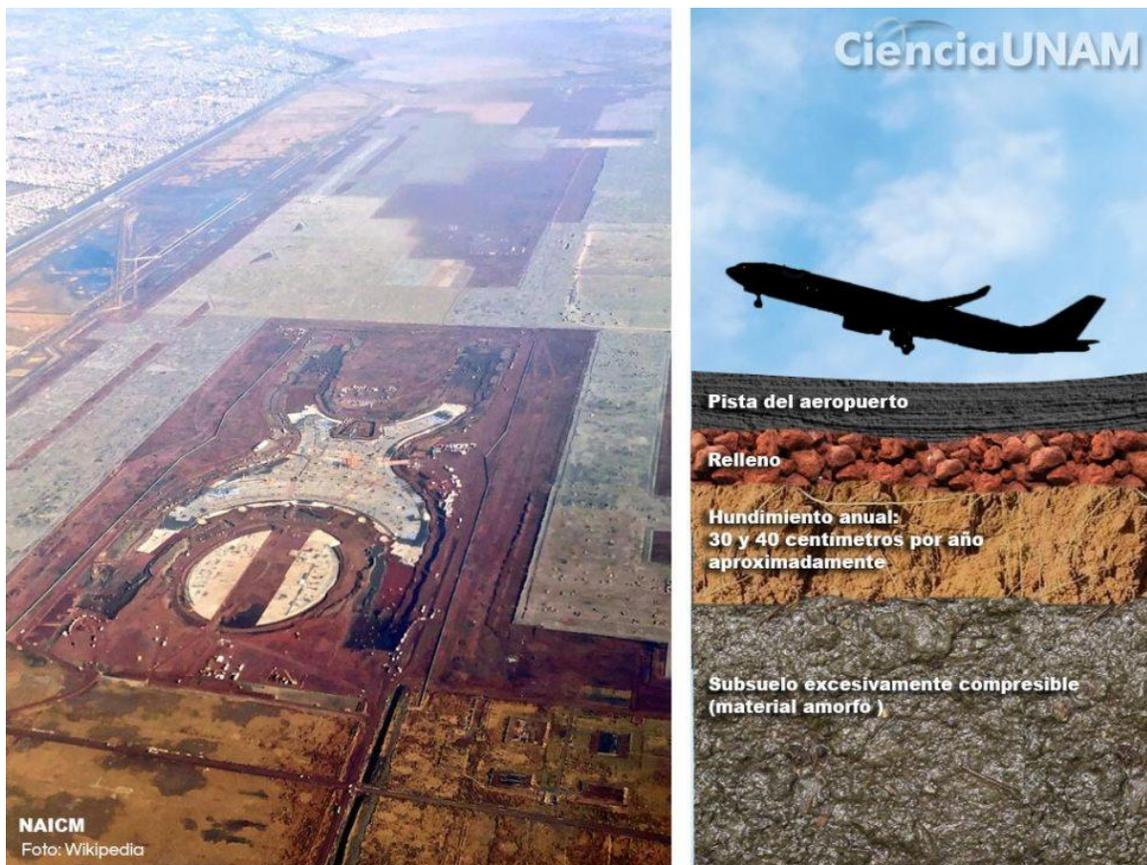
Fig. 1.66 En la imagen se muestra los problemas de hundimiento del Aeropuerto de Texcoco. Fuente el portal de Ciencia UNAM (Ciencia UNAM)
