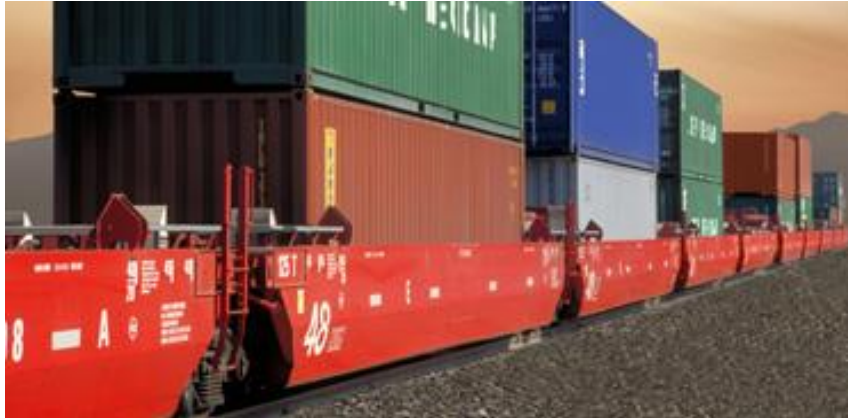
Ilustración 6 Doble estiba de contenedores (Ferromex, 2020).
