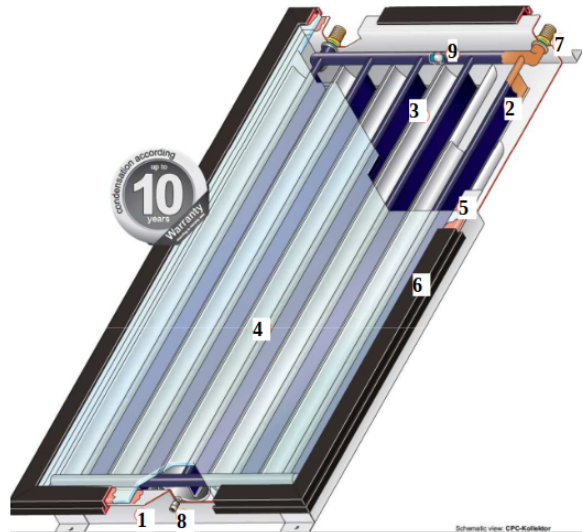
Figura 1.9: Componentes del captador solar CPC SOLARFOCUS (22).
