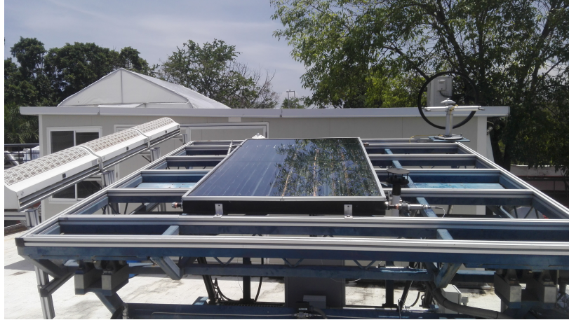
Figura 6.2: Captador solar CPC, pruebas de rendimiento térmico en el laboratorio LAPECAS-IER-UNAM.
