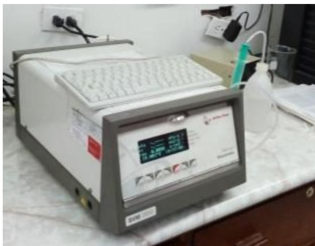
**Figura 5.** Viscosímetro Anton-Paar utilizado para realizar las mediciones de viscosidad y densidad.
