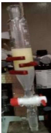
**Figura 9.** Proceso de lavado del biodiésel realizado con aceite obtenido con el equipo Soxhlet.
