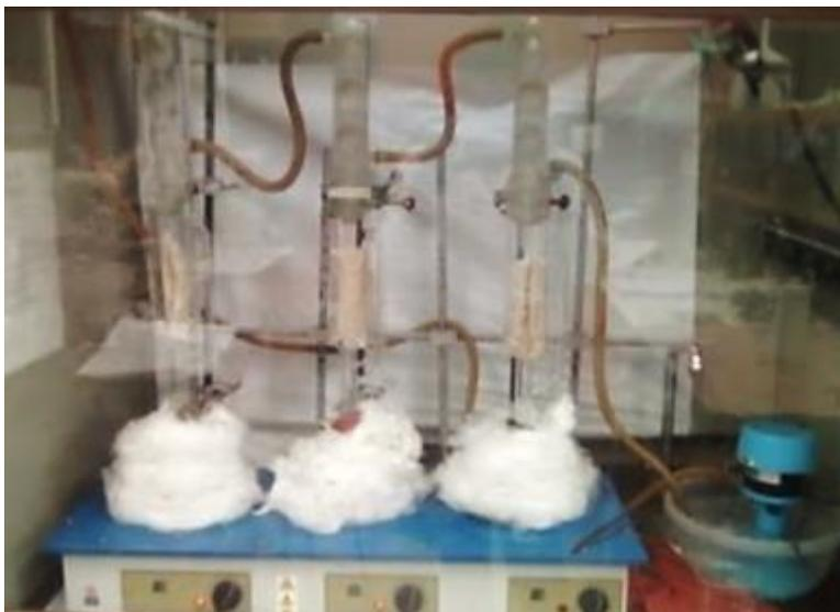
**Figura 2.** Extracción de aceite de semilla de ciruela pasa (*Prunus domestica* L.) mediante el equipo Soxhlet.
