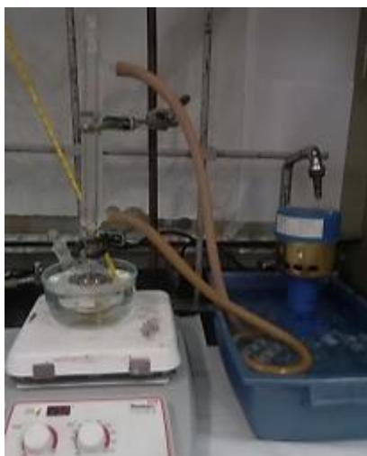
**Figura 4.** Equipo utilizado en la reacción de transesterificación para la obtención de biodiésel de semilla de ciruela pasa (*Prunus domestica* L.)
