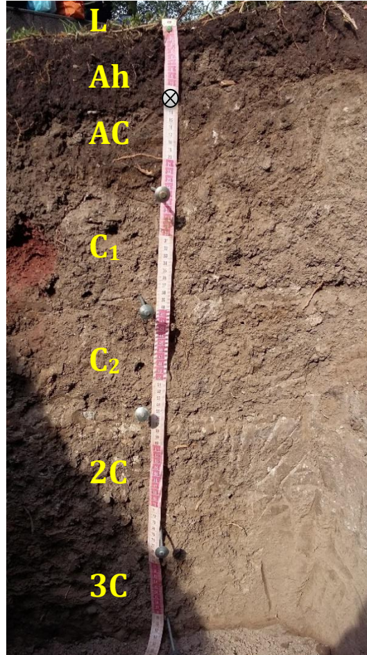
Figura 42. Perfil 01, en la foto se observan los seis horizontes delimitados.
