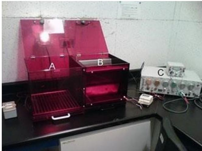
**Figura 6. Cámara de evitación inhibitoria. A.** Compartimento de seguridad. **B.** Compartimento de castigo. **C.** Estimulador de pulsos cuadrados.
