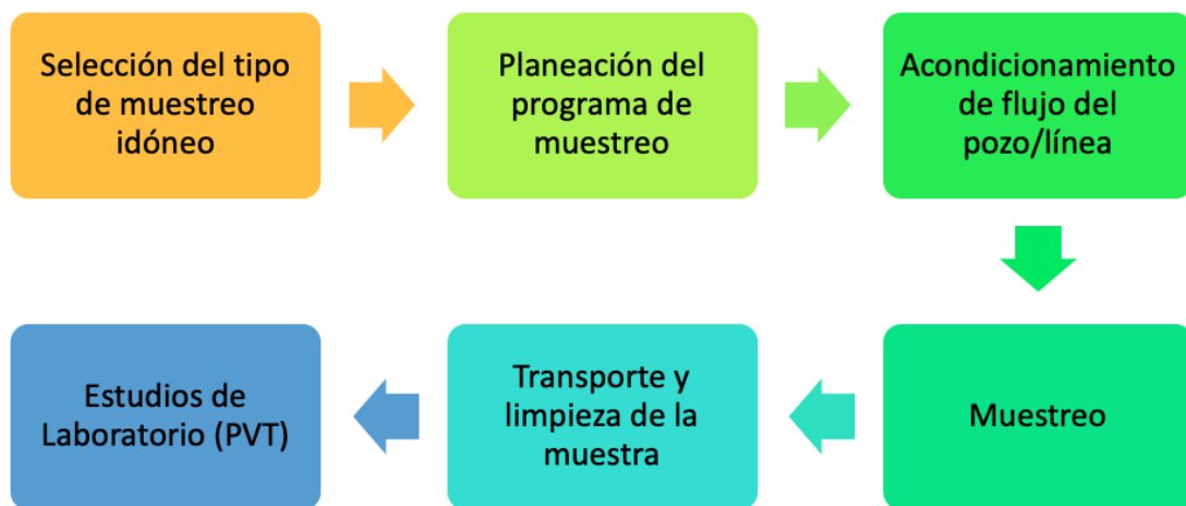
Figura 1.1: Proceso general del muestreo de fluidos.
