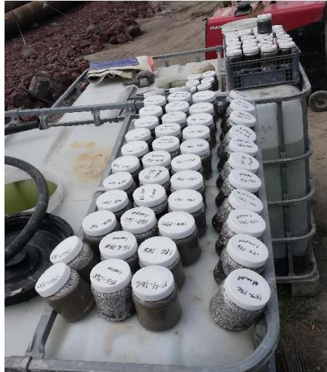
*Ilustración 50 Muestras de suelo debidamente lavadas y clasificadas de acuerdo con la profundidad de extracción.
