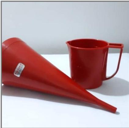
*Ilustración 30 Instrumentos para la prueba "Viscosidad de Marsh"*
