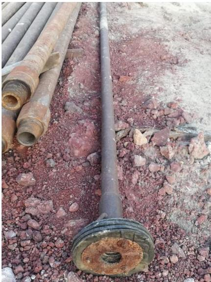
Ilustración 61 Pistón con punta de neopreno.
