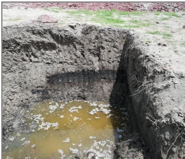
*Ilustración 27 Indicios de la exposición del Nivel de Aguas freáticas. Fuente: Elaboración propia.*
