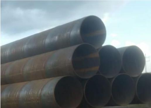
*Ilustración 6 Tubería lisa con cordón helicoidal. Fuente: Elaboración propia.*
