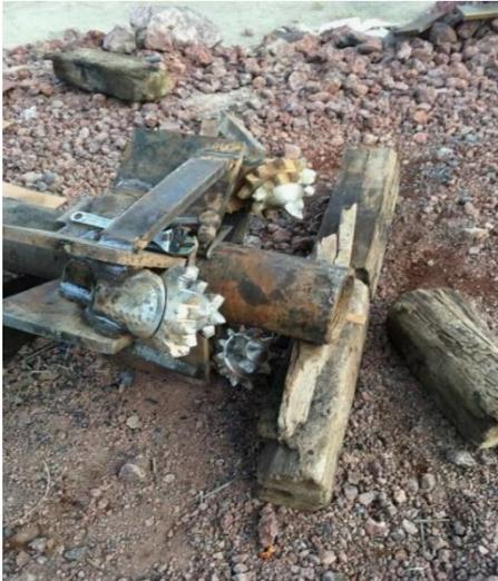
La perforación se llevó a cabo mediante barrena de diámetro 12 ¼" en su etapa exploratoria, posteriormente se con el ampliador, se logró un diámetro de 18 ¾", ambas perforaciones se iniciaron desde los 200.80 metros hasta los 400.00 metros de profundidad, tal como lo establecen las especificaciones técnicas.
