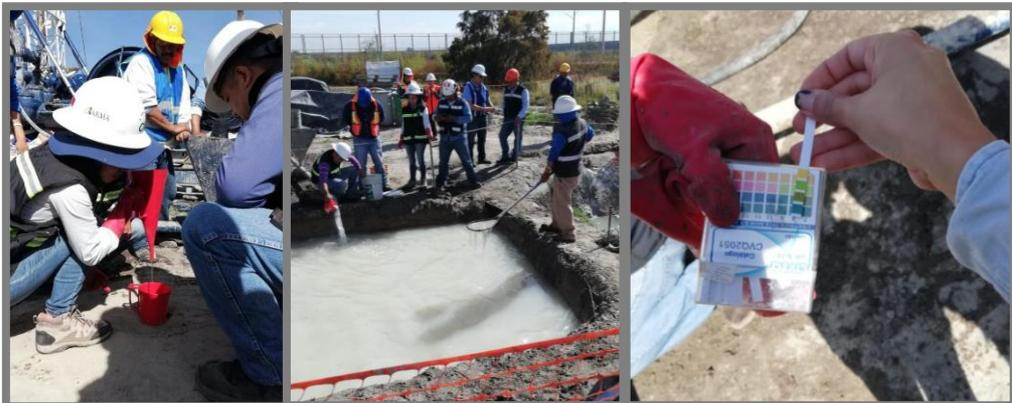
Ilustración 32 Medición de pH del agua mezclada con polímero.
