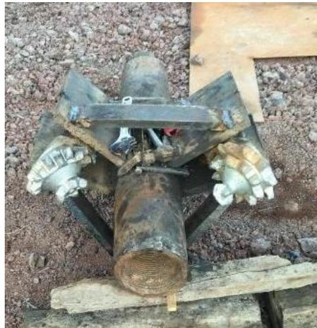
*Ilustración 3 Ampliador con barrena tricónica.
