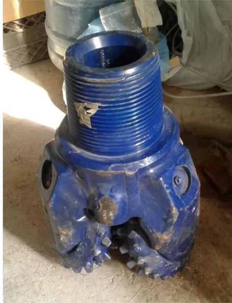
*Ilustración 17 Brocal tricónico con incrustaciones de metal.
