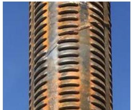
*Ilustración 7 Tubería ranurada. Fuente: Elaboración propia.*
