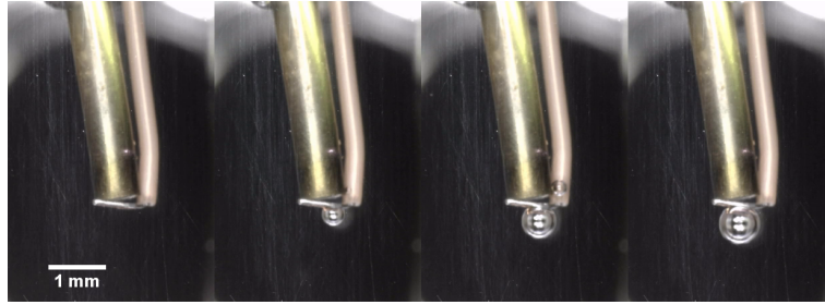
Figura 5.33: Prueba cualitativa de calor para evaluar la capacidad térmica del DF-1C-5nm. El DF-1C-5nm junto con el termopar fueron sumergidos en metanol. El calor generado provocó la formación de una burbuja.
