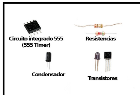
Figura Addendum 1 — Imagen que muestra, a una escala aproximadamente real, algunos de los elementos principales del circuito 555, imágenes tomadas de Semiconductor Museum . Fuente en Internet: consultar p. 7
