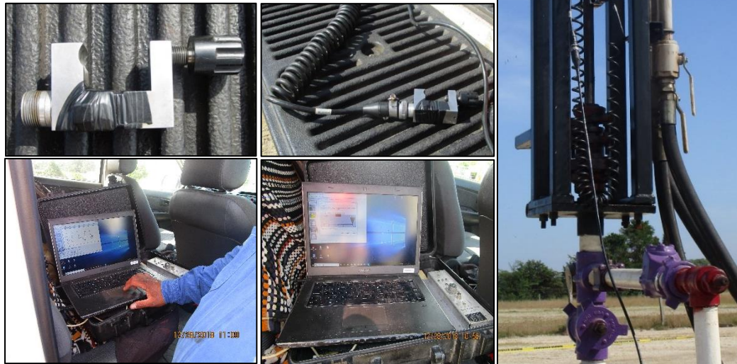
Figura 3.12 Toma de carta dinamométrica con celda de carga tipo PRT
