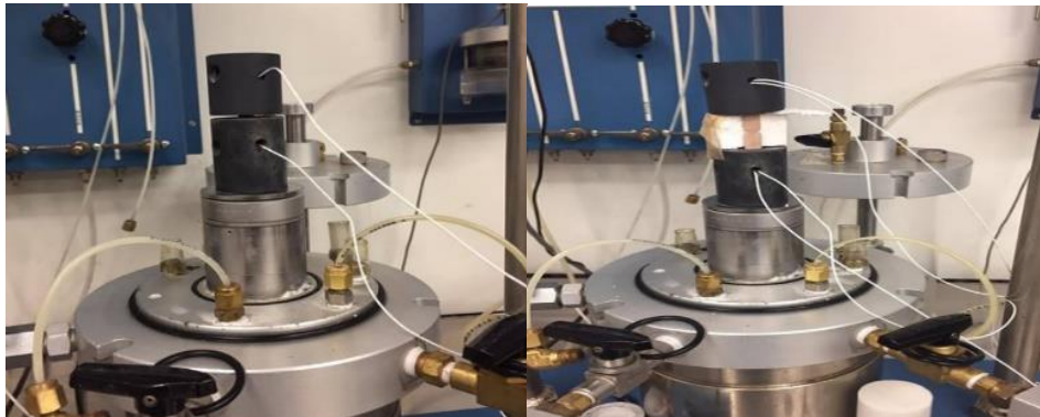
Figura 3.6 Determinación del tiempo de retardo de los elementos de compresión (izquierda) y determinación del tiempo de retardo de los elementos de flexión (derecha)
