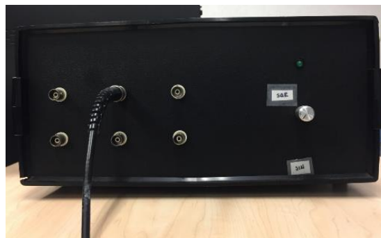
Figura 3.12 Generador de funciones modelo Wavetek 175
