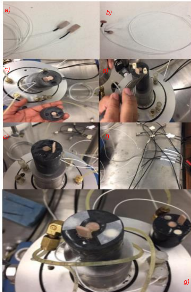
Figura 3.5 Instrumentación de cabezal y pedestal con los elementos bender; a) elementos de flexión instrumentados, b) elementos de compresión instrumentados, c) colocación de elementos bender en el cabezal y pedestal, d) colocación de resina epóxica, e) secado de resina epóxica, f) conexión de cables coaxiales y g) cabezal y pedestal instrumentados
