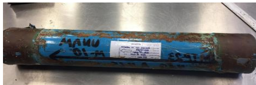
Figura 4.1 Tubo Shelby del sondeo con la muestra de suelo
