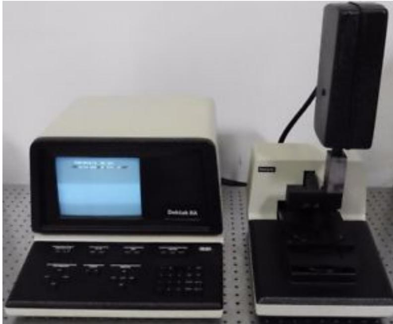
Figura 10: Perfilómetro para obtener el espesor y rugosidad de las películas
