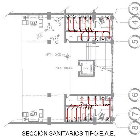
SECCIÓN SANITARIOS TIPO E.A.E.
