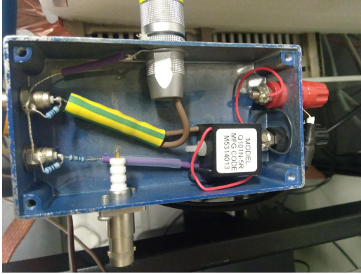
Figura 2.8: Caja de conexiones de alto voltaje para el MRPC, se muestra el convertidor a alto voltaje y las resistencias que sirven como divisores de voltaje para la lectura con multímetro.
