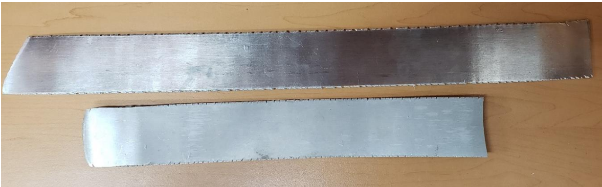
Figura 50. Muestras laminadas en frío para alcanzar un espesor de 1mm, en la imagen superior se observa una muestra sin tratamiento térmico y en la imagen inferior se observa una muestra con tratamiento térmico.
