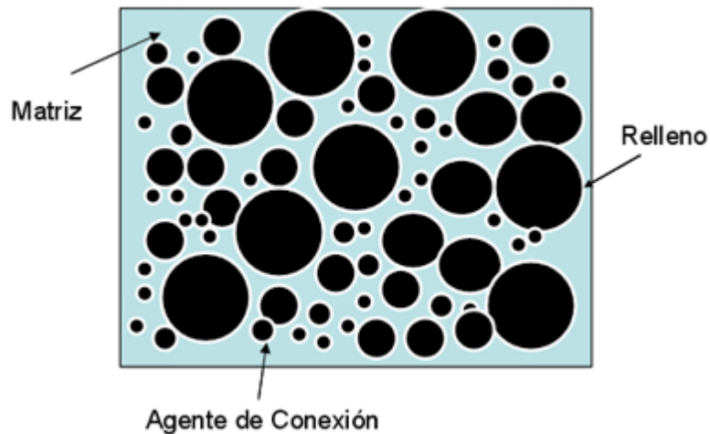
Figura 3. Componentes fundamentales de las resinas compuestas. Esquema general donde puede verse la matriz de resina, las partículas de relleno y el agente de conexión. 1
