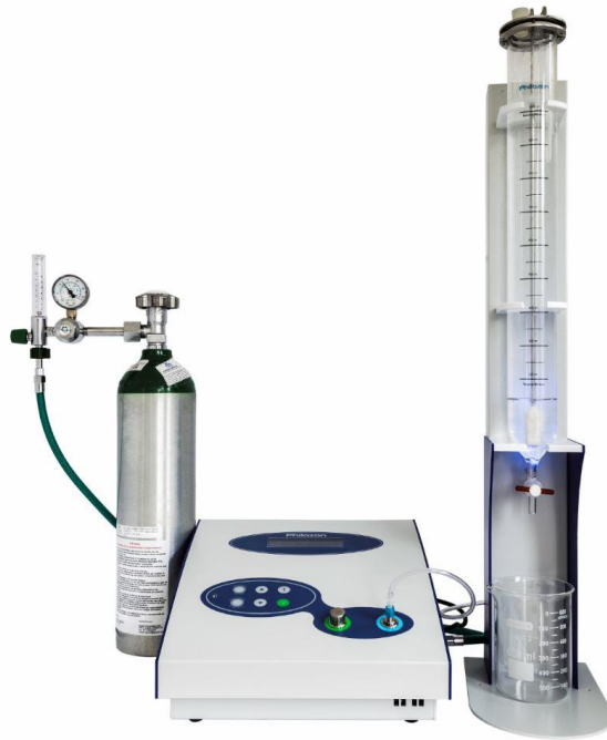
Fig. 17 Columna para ozonización del agua, promueve la difusión del ozono en el agua a través del contacto de microburbujas de gas con el líquido. 53
