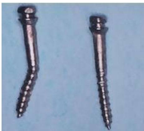
Figura 10. Aplicación de fuerza muy rápida al hueso/mini implante, resultando en una deformación del mini implante. 14
