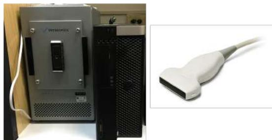
**Figura 3.13:** Imagen de un equipo de ultrasonido Verasonics Vantage 128 y un transductor lineal L11-5v.
