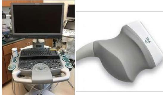
**Figura 3.12:** Imagen de un equipo de ultrasonido Siemens Acuson S2000 y un transductor lineal 18L6.
